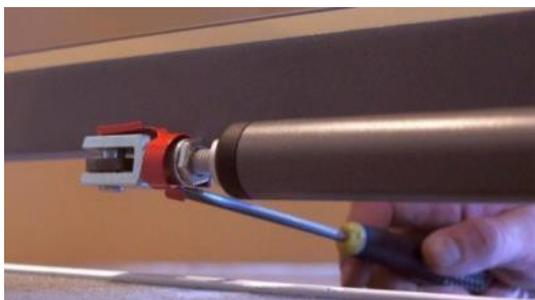
1. Retirez le ressort de l'arbre de broche à l'aide d'un outil adapté, comme un tournevis, une règle, un décapsuleur, etc.
